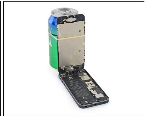
**⚠ Attention : ne cherchez pas à retirer le panneau frontal ! Il est encore relié au châssis par plusieurs nappes.**
